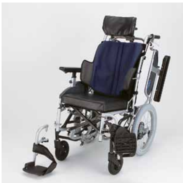
●型式:NAH-F5 ●メーカー:日進医療器 ●折りたたみサイズ(cm):全幅33 ●チルト角度:4~30° ●材質:アルミ
